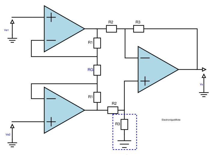
L'amplificateur d'instrumentation ou de mesure est basé sur le principe de l'amplificateur différentielle amélioré. La sortie Vs est la différence des deux entrées (Ve1 et Ve2) multipliée par un gain G.
