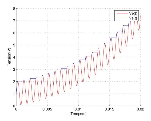
Le deuxième AOP sert à maintenir la valeur crête pour long temps. En pratique le condensateur ne tient pas la valeur finale su signal pour une durée infini à cause de la décharge de la capacité à travers l'impédance commun de l'amplificateur opérationnel.
