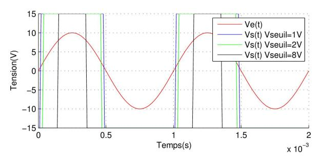
Dans la pratique on utilise pas un comparateur simple, si la tension d'entrée fluctue, le système bascule un certain nombre de fois avant de de trouver sont état d'équilibre. Avec un comparateur à hystérésis, le système n'oscille pas si l'écart entre les seuils est supérieur à l'amplitude des fluctuations du signal d'entrée.
