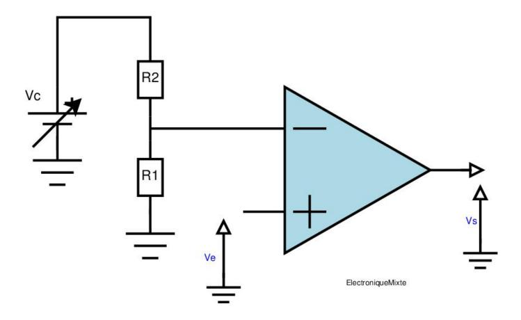
Note : la tension Vc peuvent etre generé par un microcontrolleur. Le role du pont diviseur est de définir ( zoomer) la dynamique minimale et maximale de la tension du seuil.
