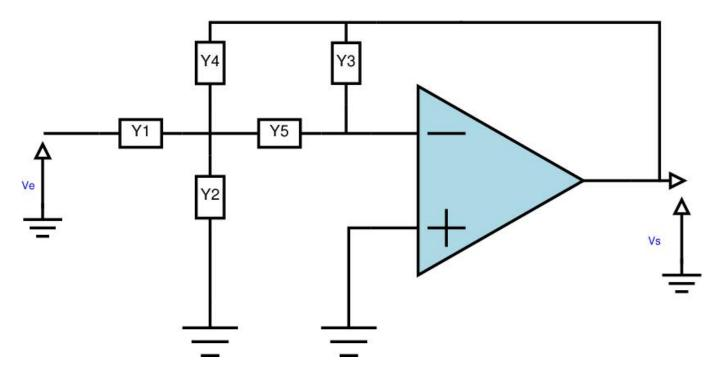
Cette structure très classique utilise un AOP monté amplificateur (contre réaction négative) et cinq admittances.
